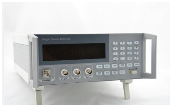
图 25: 近红外单光子探测器 SPD4
